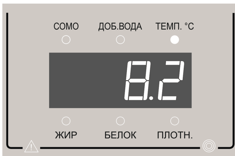
Рисунок 2.13 – Настройка порога СОМО, контрольное значение СОМО 8,20
