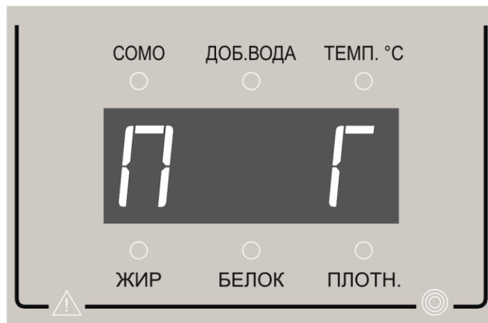
Рисунок 2.12 – Анализатор находится в режиме подкалибровки.
