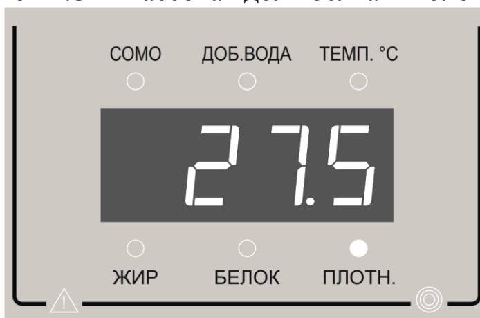
Рисунок 2.9 – Плотность молока 27,5 в градусах ареометра (1027,5 кг/м 3 )
